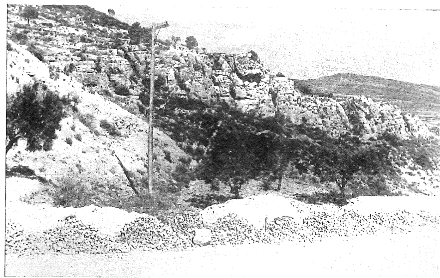
Fot. 18.—Calizas aptenses horizontales en el P. K. 10,7 de la carretera de Almansa.
